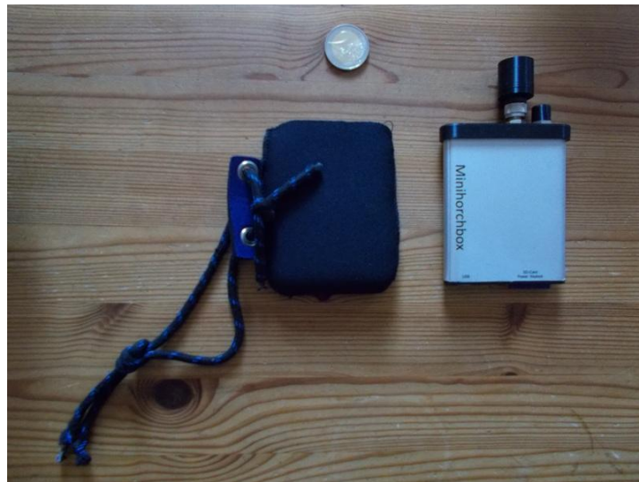
Abb. 1: Mini-Horchbox der Firma albotronic und Wetterschutzhülle aus Neopren
